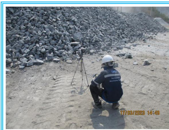
รูปที่ 4.3-9 แสดงการตรวจวัดค่าความทึบของฝุ่นละออง (Opacity) บริเวณปลายสายพานลำเลียง (ภายนอกอาคาร) วันที่ 17 มีนาคม 2566
