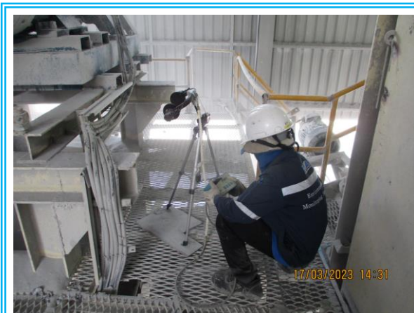
รูปที่ 4.3-7 แสดงการตรวจวัดค่าความทึบของฝุ่นละออง (Opacity) บริเวณปากโมชั้นที่ 2 วันที่ 17 มีนาคม 2566
