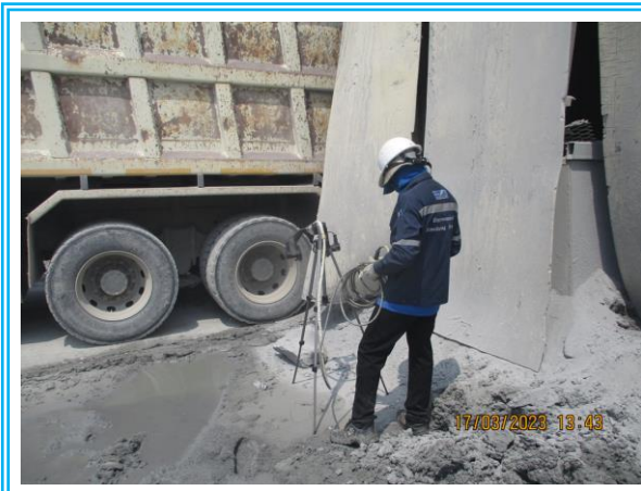
รูปที่ 4.3-5 แสดงการตรวจวัดค่าความทึบของฝุ่นละออง (Opacity) บริเวณยู่รับหิน วันที่ 17 มีนาคม 2566
