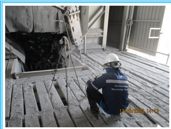
รูปที่ 4.3-6 แสดงการตรวจวัดค่าความทึบของฝุ่นละออง (Opacity) บริเวณปากโมหินใหญ่ วันที่ 17 มีนาคม 2566
