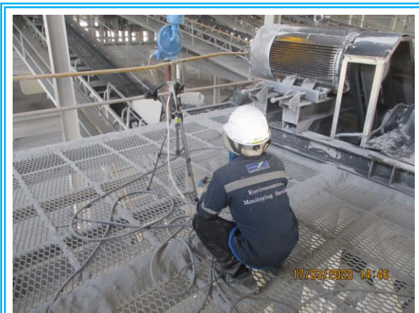
รูปที่ 4.3-8 แสดงการตรวจวัดค่าความทึบของฝุ่นละออง (Opacity) บริเวณตะแกรงคัดขนาด วันที่ 17 มีนาคม 2566
