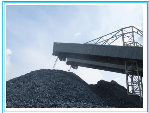
รูปที่ 3-18 สายพานลำเลียงแบบปิดคลุม
