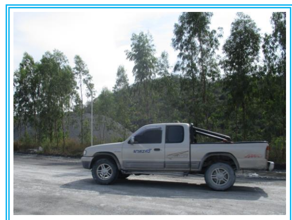
รูปที่ 3-22 รถไซเรน (เปิดสัญญาณเตือนก่อนระเบิดหิน)
