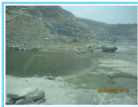
รูปที่ 3-6 บ่อดักตะกอน (Sump)
